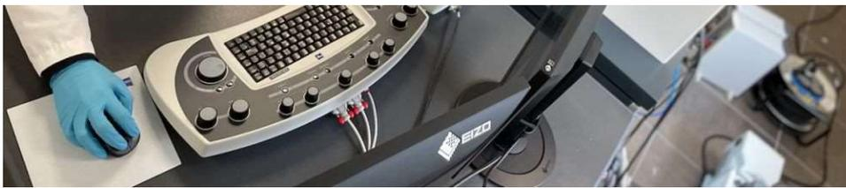
Ce microscope électronique à balayage (MEB) qui identifie notamment la nature chimique d'un dépôt ou d'une particule, contrôle un traitement de surface, expertise les défaillances ou analyse encore la morphologie d'une poudre. © Filab
