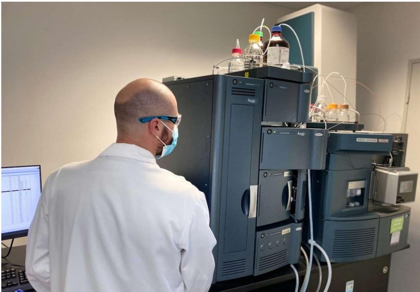
Ce nouvel équipement de Filab s'utilise notamment pour l'identification d'impuretés, par exemple dans l'analyse physico-chimique des dispositifs médicaux, pour la déformulation de substances organiques ou pour l'identification de pics parasites.
