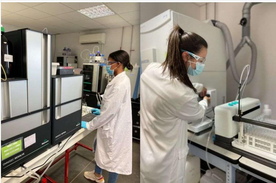
Photo de gauche : L'analyse par GPC (chromatographie par perméation de gel), couplée à des détecteurs RI ou UV, est utilisée pour caractériser certaines propriétés physico-chimiques des polymères ou des composites. Elle sépare les molécules dissoutes selon leur taille ou leur poids moléculaire.
